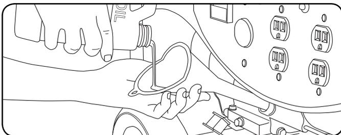
2. Retirez le bouchon/jauge du réservoir d'huile pour ajouter de l'huile.
