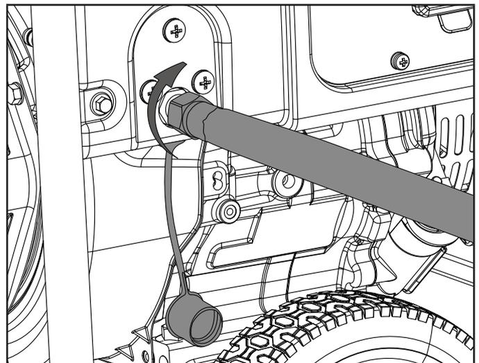
5. Revise todas las conexiones en busca de fugas mojando las conexiones con una solución de agua y jabón. Burbujas que aparecen o las burbujas que crecen indican que existe una fuga. Si existe una fuga en una conexión, cierre la válvula en el tanque y apriete la conexión. Gire para abrir la válvula de nuevo y vuelva a comprobar la conexión con el jabón y agua. Si la fuga continúa o si la fuga no está en una conexión, entonces no use el generador y contacte al servicio al cliente.
