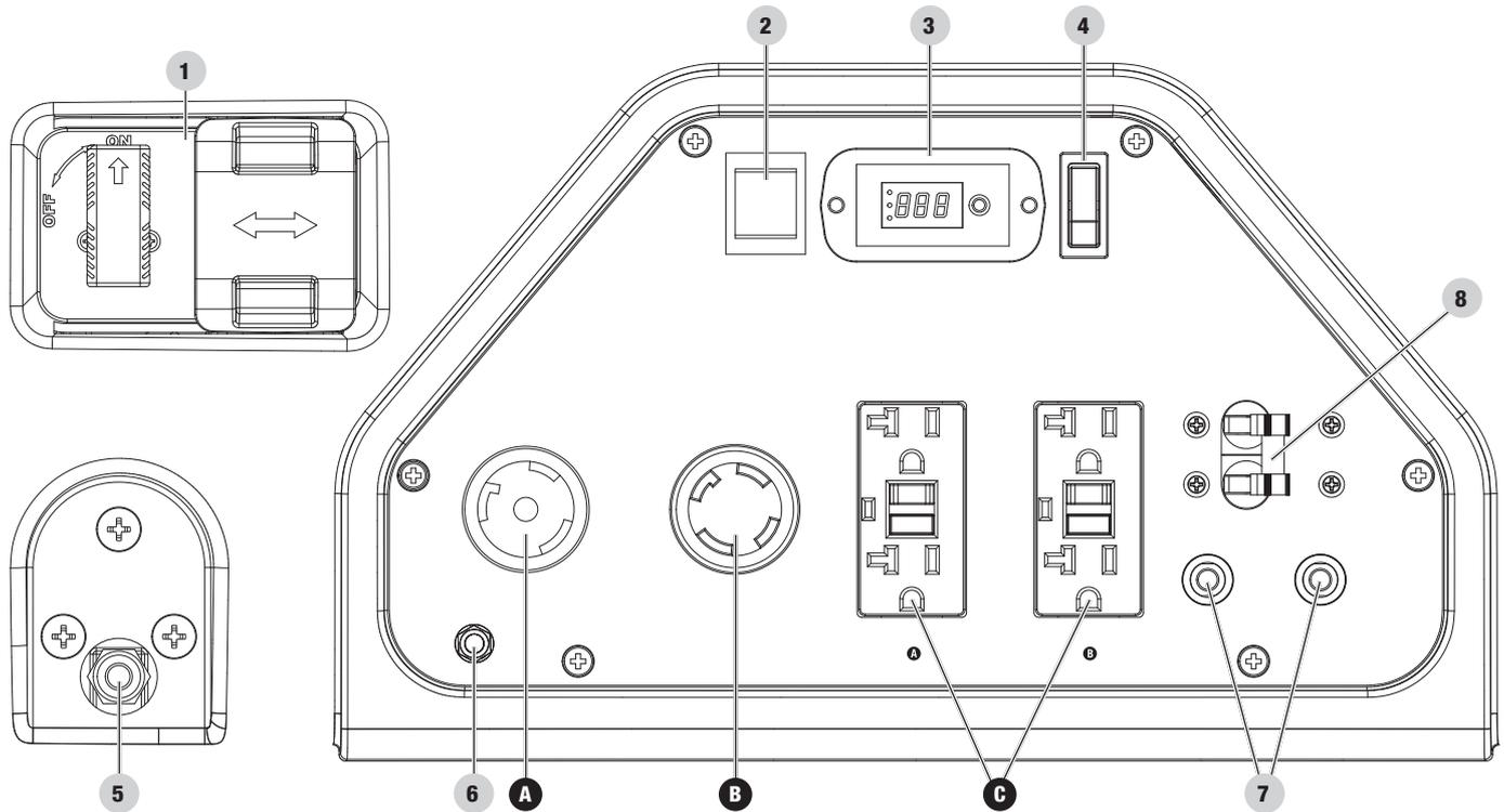
1. **Selector de combustible** – Utilizado para seleccionar y activar la fuente de combustible de gasolina o propano (GLP).
