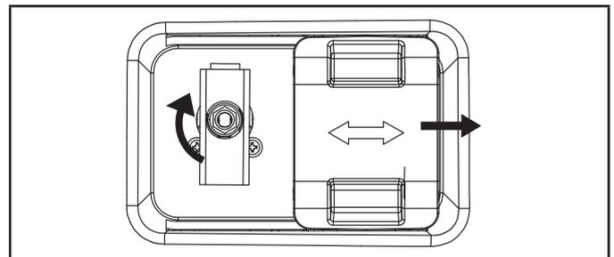
Para elegir propano (GLP), deslice el selector hacia la izquierda. Girar la válvula de combustible en una posición de 90° grados en el sentido de las manecillas del reloj.
