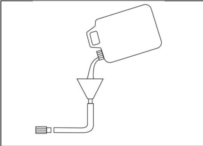
5. Versez l'antigel dans l'entonnoir, puis tirez sur le cordon de démarrage du moteur pour créer une succion dans le boîtier de la pompe. Tirez le cordon de démarrage plusieurs fois jusqu'à ce que l'antigel sorte par la sortie de la pompe.
