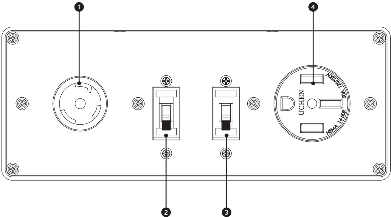
1. **Receptáculo de bloqueo giratorio de 120 Voltios CA, 30 Amperios (NEMA L5-30R)** – Utilizado para suministrar cargas monofásicas de 120 voltios CA, 60 Hz.
