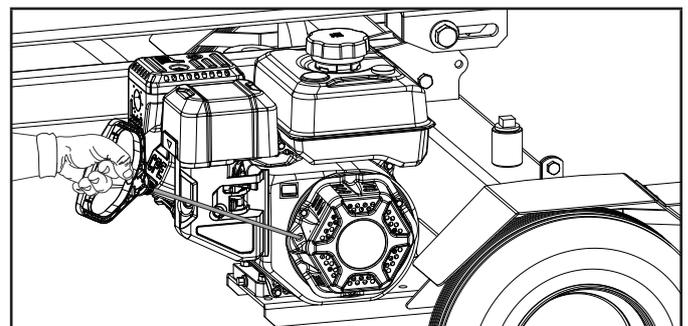
5. A medida que el motor se calienta, mueva la palanca del ahogador a la posición "CORRER".
