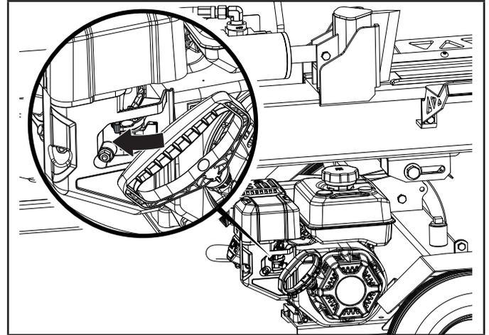
3. Gire la válvula de combustible a la posición "ENCENDIDO".
