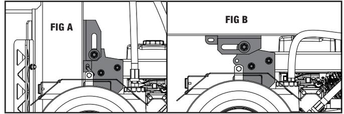
4. Gire la viga a la posición horizontal y asegúrelo con el pasador de seguridad (54) y pasador en R (56) a través de la barra de remolque.
