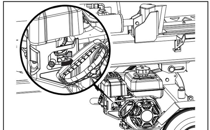
4. Tire del cable de arranque hasta que se sienta la resistencia y luego tire rápidamente.
