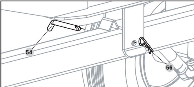
3. Inserte el pasador y pasador en "R" en el orificio de seguridad (en la base de la barra de remolque).
