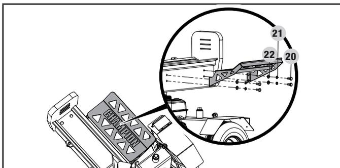
**Receptor de tronco chico (lado de la manguera hidráulica)**
