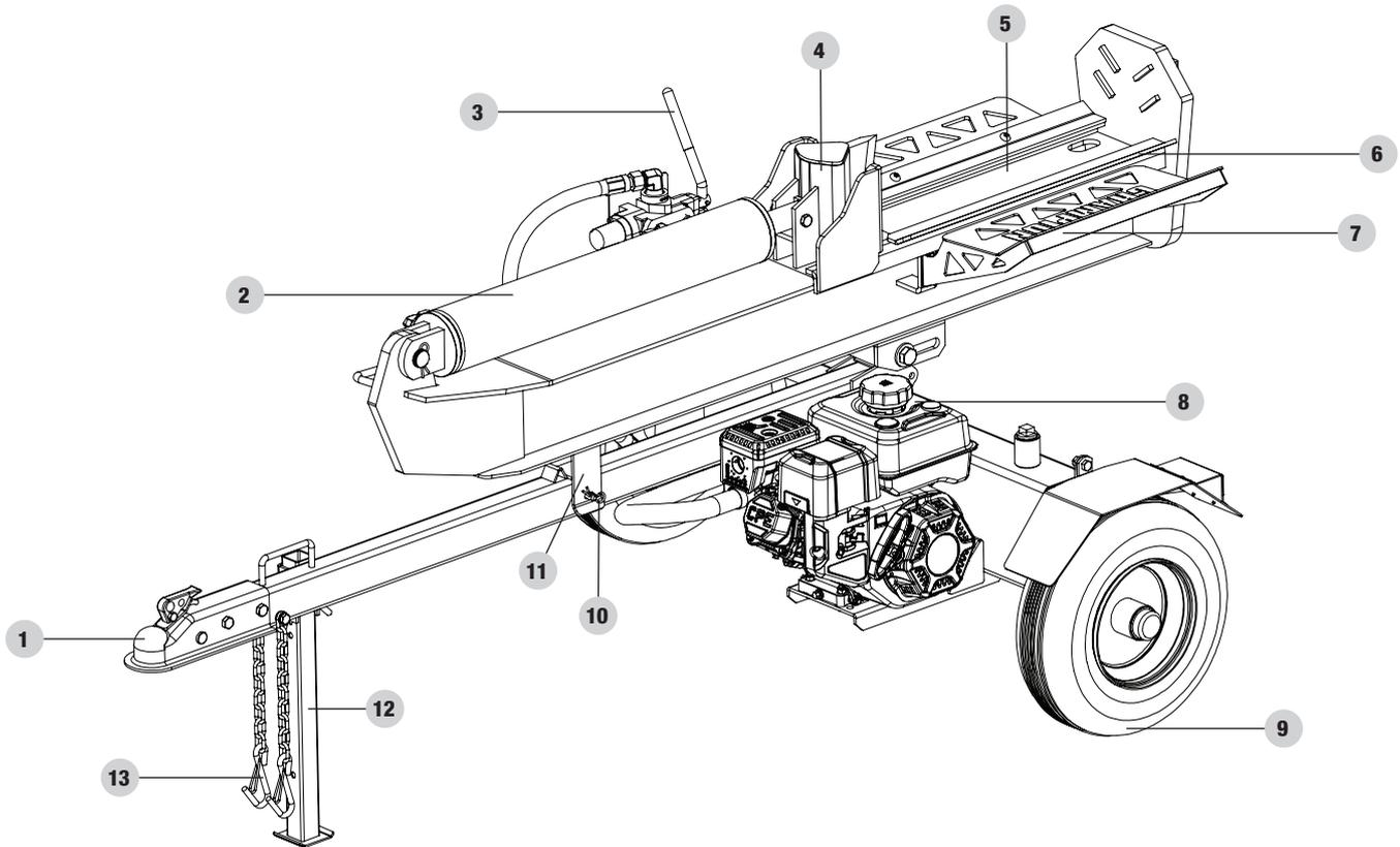
1. **Acoplador de remolque de 2 in. (5.1 cm)** – Para remolcar el partidor de troncos detrás de su vehículo.
