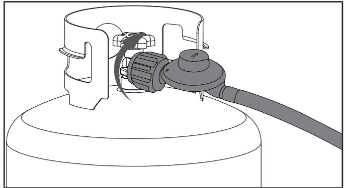
5. Revise todas las conexiones en busca de fugas mojando las conexiones con una solución de agua y jabón. Burbujas que aparecen o las burbujas que crecen indican que existe una fuga. Si existe una fuga en una conexión, cierre la válvula en el tanque y apriete la conexión. Gire para abrir la válvula de nuevo y vuelva a comprobar la conexión con el jabón y agua. Si la fuga continúa o si la fuga no está en una conexión, entonces no use el generador y contacte al servicio al cliente.
