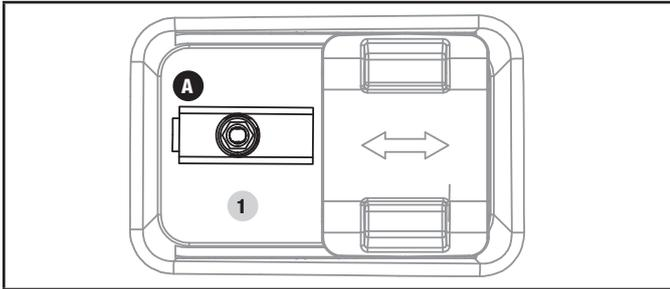
Una vez que se ha seleccionado una fuente de combustible, el usuario debe girar la válvula de combustible a la posición vertical para abrir la válvula de combustible (1).
