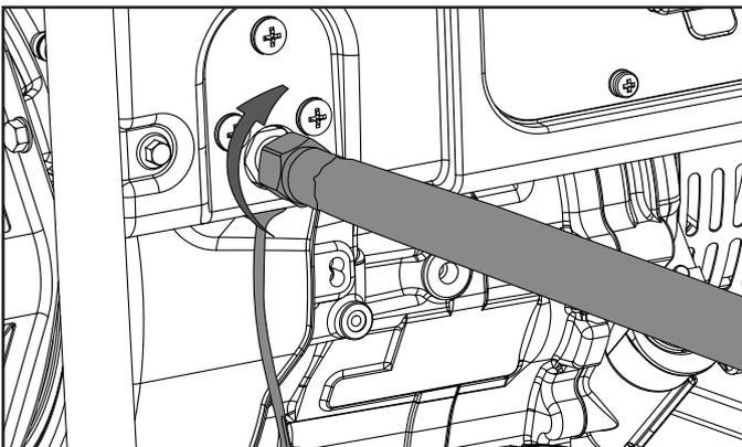
3. Retire el tapón de seguridad o la tapa de la válvula del cilindro.
