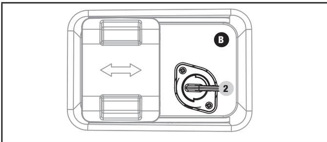
Para poner la válvula de combustible a la posición "APAGAR" la válvula se debe girar a la posición horizontal (2).
