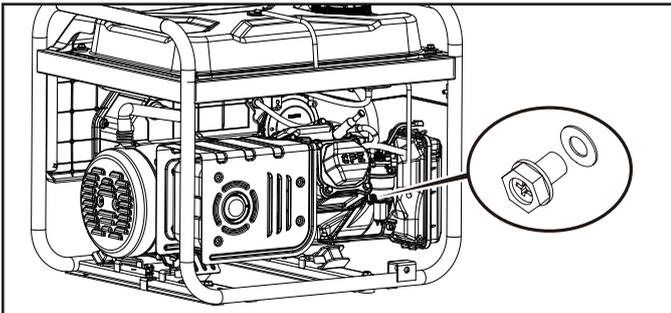
5d. Cuando la gasolina pare de fluir del carburador, reemplace y apriete el perno de drenaje del carburador y asegúrese de deshacerse de la gasolina drenada en acuerdo con las regulaciones y normas locales.
