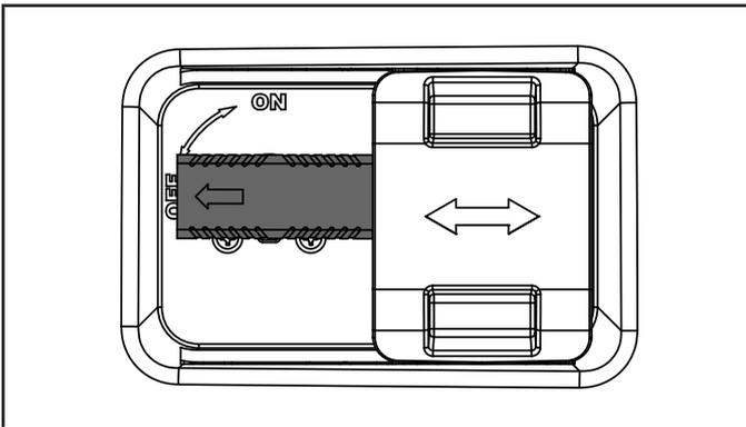
**Importante:** Siempre asegúrese de que la válvula de combustible y el interruptor del motor estén siempre en posición "APAGADO" cuando el generador no esté en funcionamiento.
