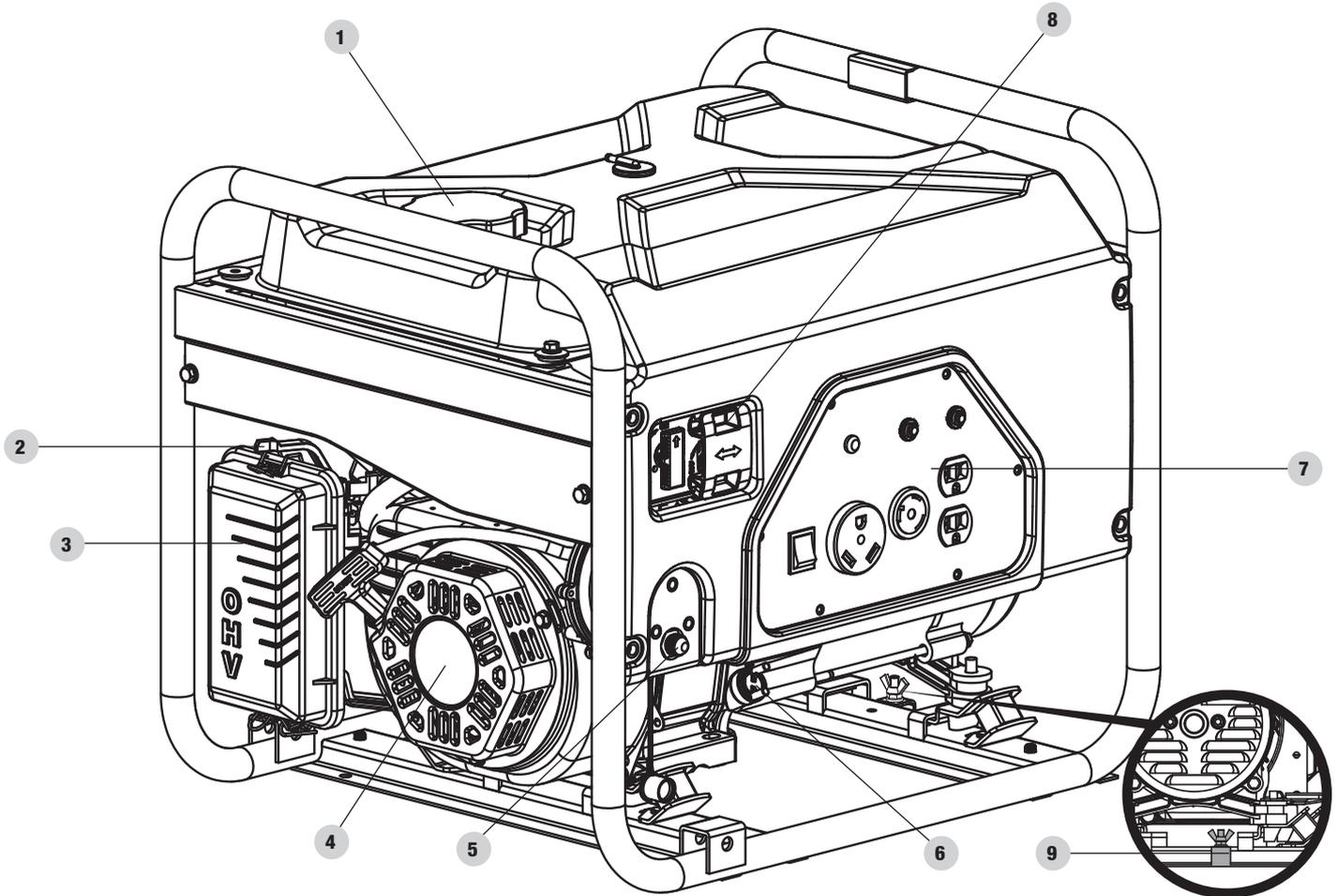
1. **Tanque de combustible de gasolina** – Tanque con capacidad de 3.4 galones (13 L).
