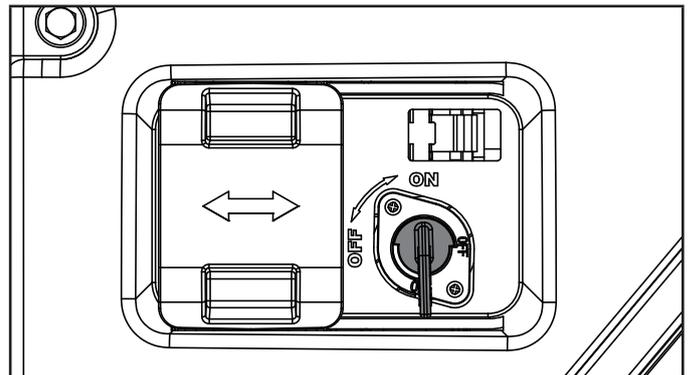
5. Oprima el interruptor del motor a la posición "ENCENDIDO."
