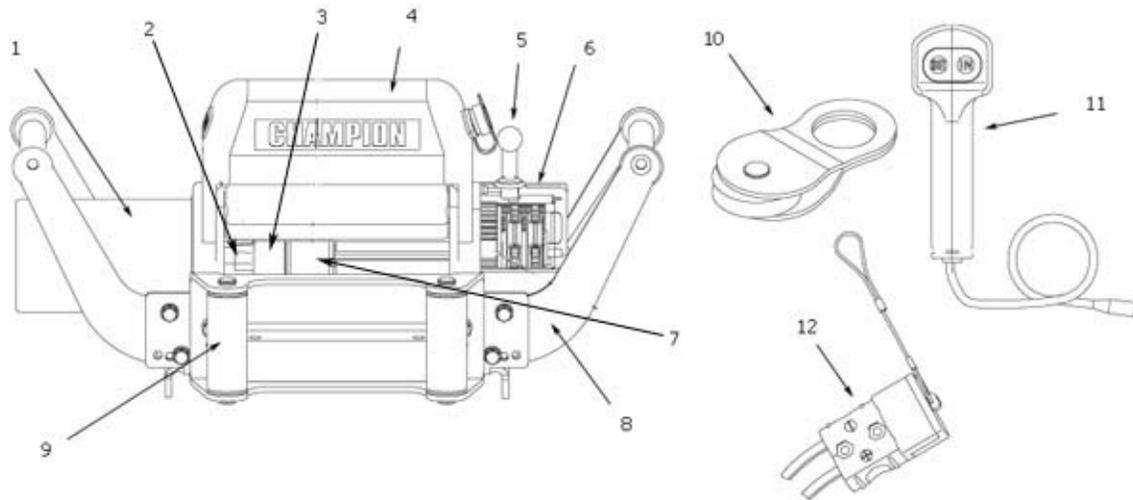
**Moteur (1) :** Un moteur de 3,6HP (2,7 KW) 12V CC assure l'alimentation du mécanisme d'engrenage planétaire.
