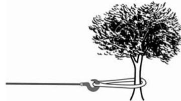
Votre treuil est muni d'un déflecteur à rouleau pour guider le câble et réduire la courbure lors d'arrimage à courte distance. N'utilisez jamais le treuil dans un angle très prononcé, car le câble s'accumulera sur un côté du tambour causant des dommages au câble et au treuil.
