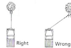
Il est possible de tirer le véhicule à angle à courte distance pour le redresser. Les tractions à grande distance devraient être effectuées avec le câble à un angle de 90° au treuil et au véhicule.
