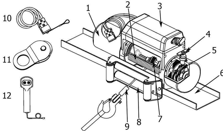
**(1) Motor** - Su motor de 3,6 Hp (Caballos de fuerza) requiere para funcionar, una batería de 12 Voltios DC y le suministra potencia a un mecanismo de transmisión que gira el tambor y enrolla el cable.
