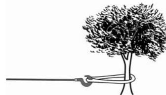
Una pieza de guía con rodillos (no incluida) le ayudará a guiar el cable y a reducir la atracción en las tracciones a corta distancia. No arrastre la carga desde un ángulo agudo ya que el cable se apilará a uno de los costados del tambor causando daños al cable y al malacate.
