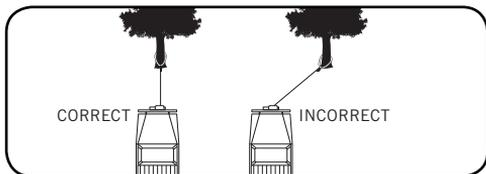
Il est possible de tirer le véhicule à angle sur une courte distance pour le redresser. Les tractions à grande distance devraient être effectuées avec la corde synthétique à un angle de 90° au treuil et au véhicule.
