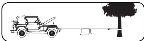
distance d'environ 1,5 à 1,8 m (5 à 6 pi) du crochet. Dans le cas où le corde synthétique se romprait, cela permettra de réduire le contrecoup. Pour plus de protection, ouvrez le capot du véhicule. Pour des charges supérieures à 1021 kg (2250 lb), il est recommandé d'utiliser la poulie coupée pour
