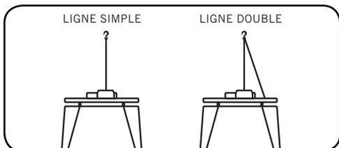
doubler la corde synthétique. Ainsi, la charge sur le treuil et la tension sur la corde synthétique sont réduites d'environ 50 %.
