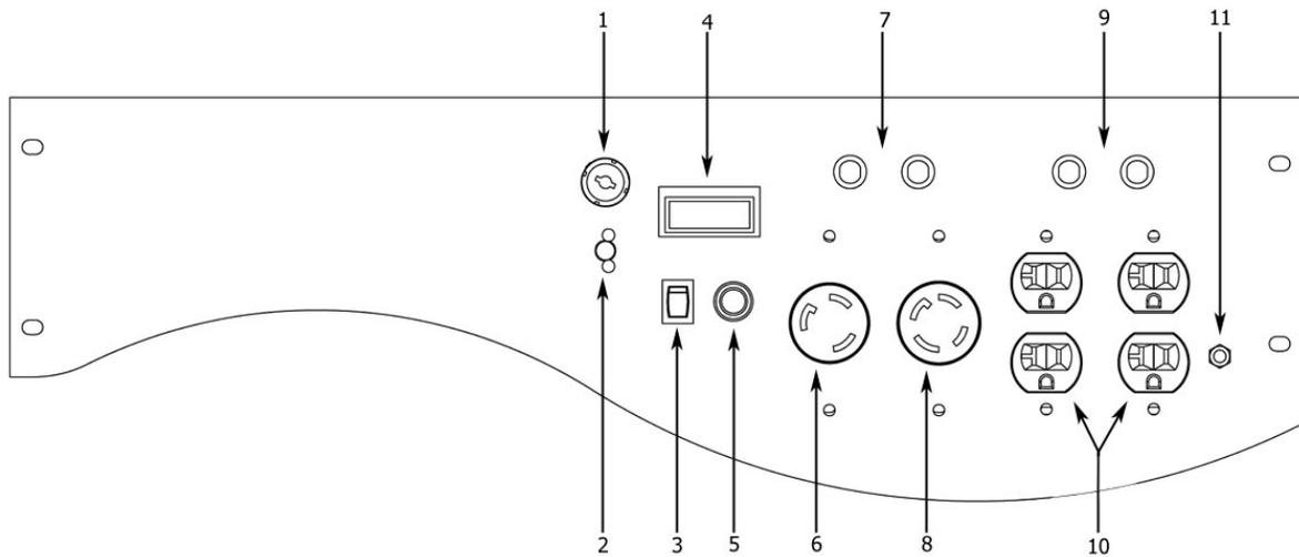
**(1) Interruptor de encendido** – Coloque el interruptor en la posición de encendido “On” para arrancar el generador.
