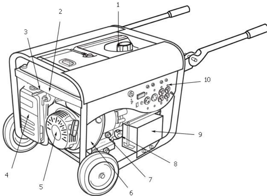
**(1) Tanque de combustible** – Tanque con capacidad de 6,5 galones.
