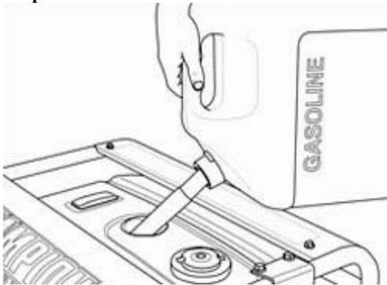
6. Atornille la tapa del tanque y limpie con un paño todo el combustible derramado.
