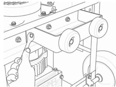
2. Fije la pata de apoyo en el bastidor del generador con los tornillos de casquete (M8x16) y las contratuercas (M8).
