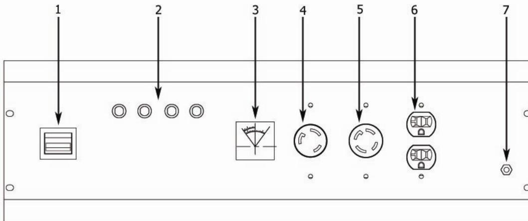
**(1) Interruptor de encendido** – Coloque el interruptor en la posición de encendido “Start” para arrancar el generador, después de 30 segundos colóquelo el interruptor en la posición de encendido “Run”. Colóquelo en la posición de apagado “Off” para apagarlo.
