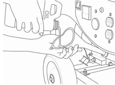
3. Agregue 1.16 cuartos de galón (1.1 L) de aceite y vuelva a colocar la tapa de llenado/varilla indicadora de aceite. En la sección "Especificaciones" encontrará las recomendaciones de aceite basadas en las condiciones de operación.
