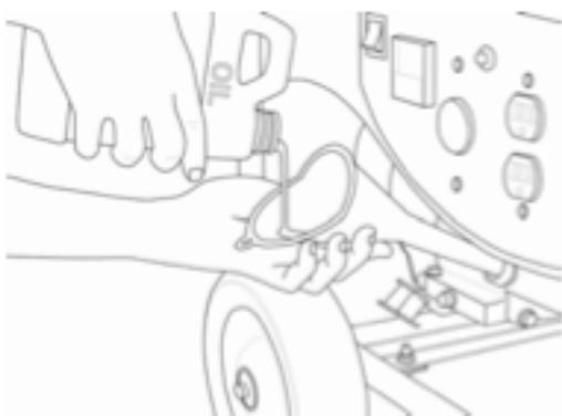
3. Ajoutez 1,1 litre d'huile et remettez le bouchon/ la jauge du réservoir d'huile.
