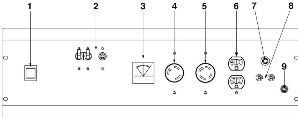
**(1) Interrupteur du moteur** – Basculez l'interrupteur sur « Start » (marche). Mettez-le sur « Off » (arrêt) pour éteindre la génératrice.
