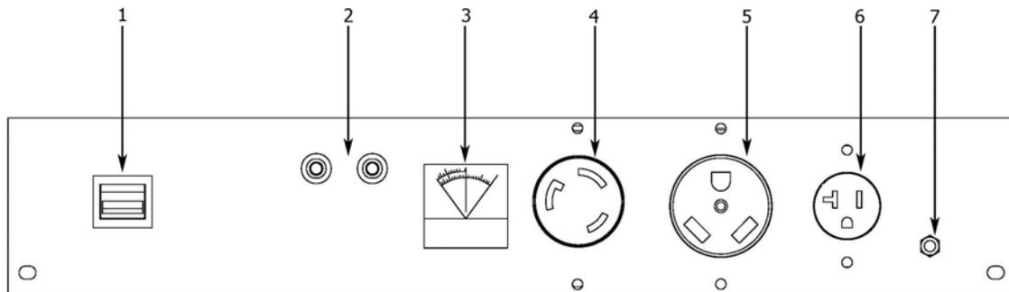
**(1) Interruptor de encendido** – Coloque el interruptor en la posición de encendido “On”. Colóquelo en la posición de apagado “Off” para apagarlo.
