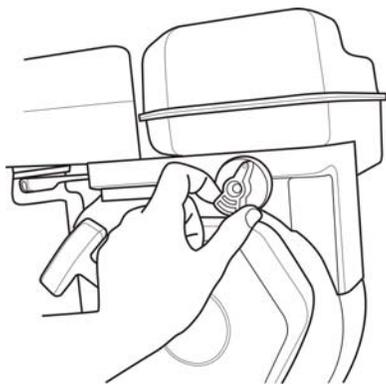
4. Mueva la palanca del obturador (Artículo A) hasta la posición de difusión "Choke" (a la izquierda).
