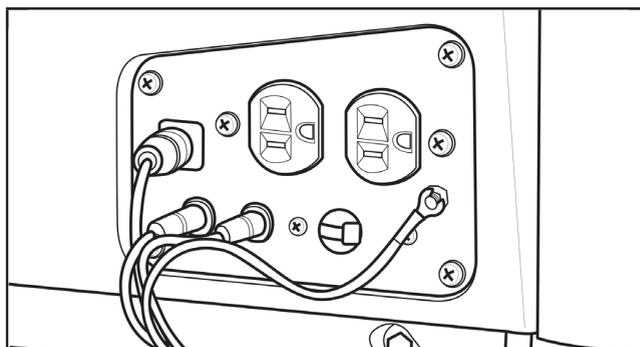
8. Démarrez le moteur des deux onduleurs selon le manuel d'utilisation de l'onduleur. Observez le témoin de sortie vert sur le panneau de chaque génératrice. Ce témoin clignotera pendant la mise en marche. Vous pouvez débrancher les dispositifs lorsque le témoin est fixe.
