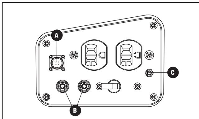
6. Branchez l'autre paire de fils d'alimentation (B), le câble de communication (A) et le fil de mise à la terre (C) à l'onduleur no 2.
