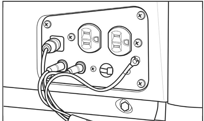
8. Arranque los motores de ambos inversores en acuerdo a su manual del operador del inversor. Observe la luz indicadora de salida verde en ambos tableros de los generadores - la luz destallará durante el arranque. Cuando la luz esté estable, usted puede conectar dispositivos.
