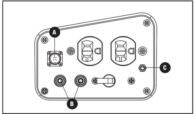
6. Enchufe el otro par de cables (B), cable de comunicación (A), y cable de tierra (C) al inversor #2.
