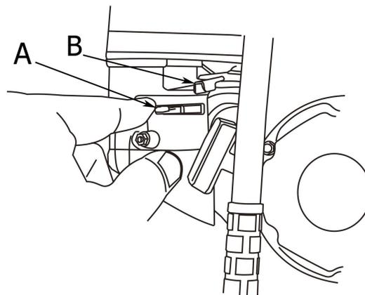
4. Tire lentamente el cable del arrancador hasta sentir resistencia, luego jálelo rápidamente
