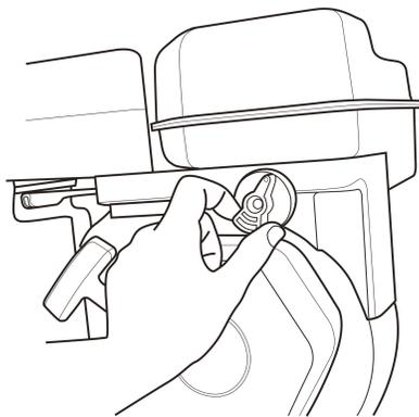
3. Mueva la palanca del obturador (Artículo A) hasta la posición de difusión "Choke" (a la izquierda).
