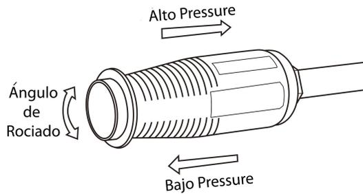
La unidad viene equipada con una boquilla de ventilación ajustable. El extremo de rociado de la vara se puede girar para producir desde un angosto chorro de alto impacto hasta un abanico de rociado de 60° de ancho.
