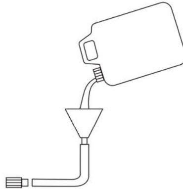
5. Vierta el anticongelante por el embudo, luego pulse el arrancador de retroceso del motor para crear succión en la caja de la bomba. Jale del retroceso varias veces hasta que el anticongelante salga por el escape de la bomba.
