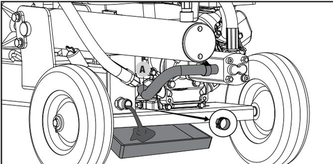
7. Retirez la jauge d'huile et ajoutez jusqu'à 5,7 l (192,7 oz liq.) d'huile hydraulique SAE 10W / ISO 32. Utilisez la jauge d'huile pour vérifier le niveau d'huile hydraulique. Le niveau doit se situer entre les deux marques de la jauge d'huile.
