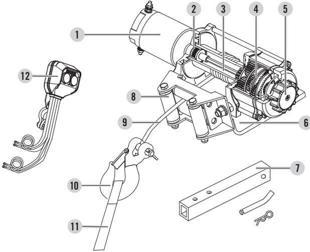
1. **Moteur** – Un moteur de 1,2 kW (1,6 HP) CC 12V assure l'alimentation du mécanisme d'engrenage planétaire.
