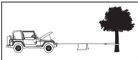
Pour une protection supplémentaire, ouvrir le capot du véhicule. Pour les tractions de plus de 1 134 kg (2 500 lb), nous recommandons l'utilisation de la poulie à chape ouvrante pour doubler la ligne de la corde.
