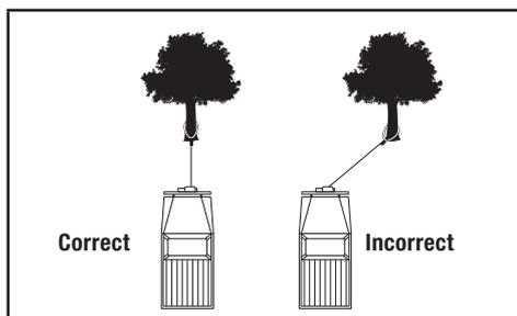
De courtes tractions sous un angle peuvent être utilisées pour redresser le véhicule. Les tractions longues doivent être effectuées avec la corde synthétique à un angle de 90° par rapport au treuil/véhicule. Lorsque vous tirez une lourde charge, placez une couverture ou une veste sur la corde synthétique à 5 à 6 pi (1,5 à 1,8 m) du crochet. En cas de bris d'un câble ou d'une corde, la couverture réduira le retour brutal de la corde.
