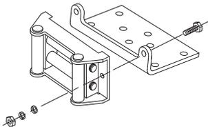
2. Para colocar el cabrestante y el canal de montaje a una superficie plana; insertar M8x35 tornillo a través la placa de base de cabrestante, a continuación, a través del canal de montaje, a continuación, a través de una superficie de montaje plana. Sujete el cabrestante y el canal de montaje con la arandela plana M8, M8 arandela de seguridad y tuerca M8 previsto.
