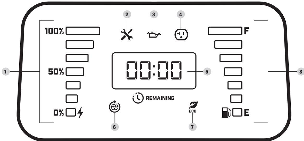
1. **Salida de Potencia** – Porcentaje de potencia disponible del generador siendo utilizada.
