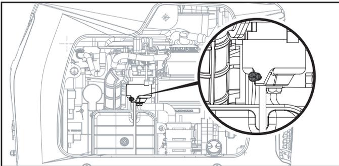
6. Lorsque le carburant ne circule plus dans la tubulure transparente, serrez fermement la vis de vidange vers la droite. Assurez-vous de jeter l'essence vidangée conformément aux règlements et directives de votre région.
