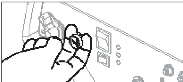
5. Poussez le interrupteur de moteur à la position « ON » (démarrage).
