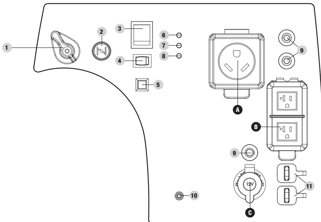
1. **Levier à robinet d'essence** – Utilisé pour sélectionner et ouvrir la source d'alimentation en carburant ou au propane.
