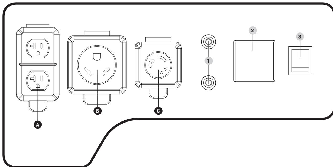
1. **Disjoncteurs (réarmement à bouton poussoir)** – Protège la génératrice contre les surcharges électriques.
