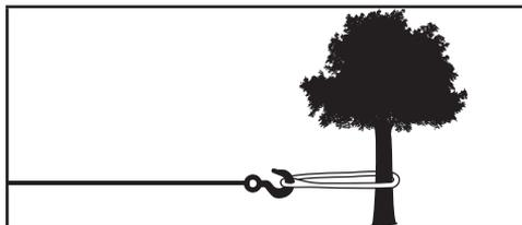
Un guía hawse de aluminio ayudará a guiar la soga y a reducir las ataduras en las tracciones a corta distancia. No arrastre la carga desde un ángulo agudo ya que la soga se apilará a uno de los costados del tambor causando daños a la soga y al malacate.
