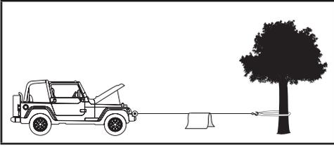
En caso de que la soga se rompa, esto amortiguará el latigazo generado luego de la ruptura. Para lograr una protección adicional, abra le cofre del vehículo. Para aparejo de cargas superiores a las 50%, le recomendamos que use un bloque de polea/arrastré (no incluido) para duplicar la resistencia de la línea de la soga.
