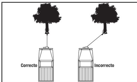
Los aparejos a corta distancia hechas en ángulo pueden ser usadas para enderezar el vehículo. Los aparejos a larga distancia deberán hacerse con la soga en un ángulo de 90° con respecto al malacate/ vehículo. Cuando jale una carga pesada, coloque una manta o una chaqueta sobre la soga a una distancia de 5-6 ft. (1.5 m-1.8 m) del gancho.
