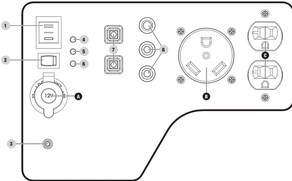
1. **Interruptor del motor** – Se utiliza para poner en modo ENCENDER o para APAGAR el generador.
