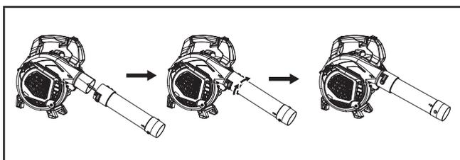
2. Assemblez le tube inférieur au tube supérieur en alignant les flèches sur les tubes. Faites glisser la cheville dans la rainure de verrouillage et faites-la pivoter dans le sens des aiguilles d'une montre pour la verrouiller.
