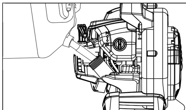
5. Ne remplissez le réservoir de carburant qu'à 80 % de sa pleine capacité. Le niveau de carburant peut être vu via la vitre du réservoir d'essence.
