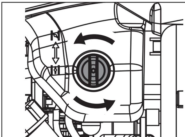
3. Inspectez, remplacez ou nettoyez le filtre à air. Pour remonter le filtre à air, assurez-vous que le filtre s'insère correctement dans la cavité et réinstallez-le comme illustré. Installez le couvercle du filtre air et fixez-le en tournant les fixations dans le sens des aiguilles d'une montre.
