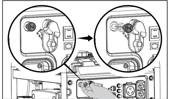
6. Jale la cuerda de arranque lentamente hasta sentir resistencia y después jale rápidamente.
