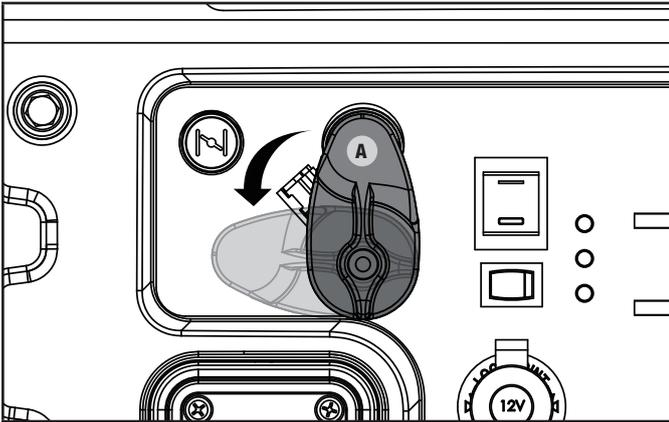
Gire el selector de combustible a la posición de horario de las 12 (vertical) para la operación de gasolina (B).
