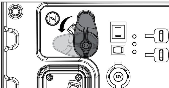
4. Abra completamente la perilla de combustible del cilindro de GLP.
