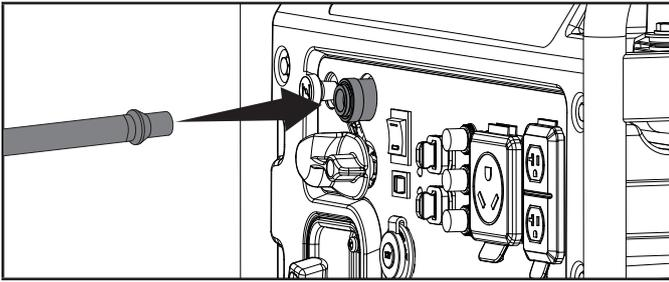
3. Retire el tapón de seguridad o la tapa de la válvula del cilindro.
