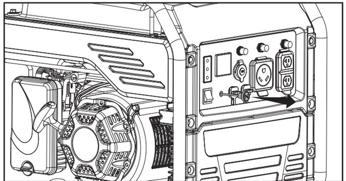
6. Jale la cuerda de arranque lentamente hasta sentir resistencia, luego jale rápidamente.
