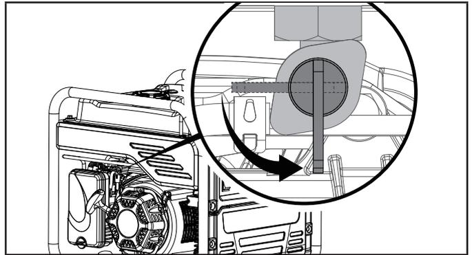
4. Oprima el interruptor del motor a la posición "ENCENDIDO".
