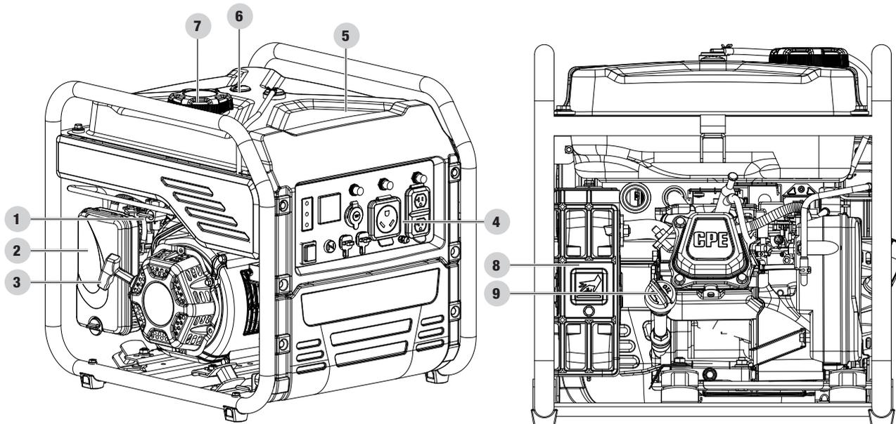
1. **Válvula de combustible** – Utilizado para apagar o encender el suministro de combustible.
