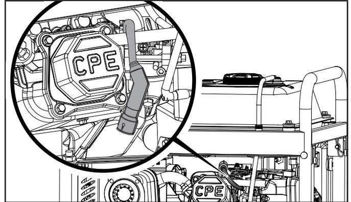
2. Utilice una herramienta para bujías (no incluida) o una llave de tubo de 13/16 in (21 mm) (no incluida) para quitar la bujía.
