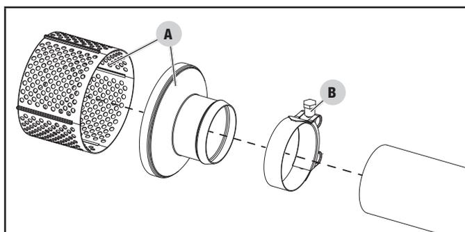
6. Coloque la abrazadera 80-85 en el otro extremo de la manguera verde. Conecte la rejilla del filtro a la manguera de admisión verde.
