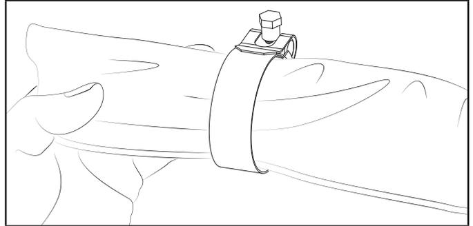
4. Deslice la manguera de descarga de color azul sobre el accesorio de conexión de la manguera de salida.
