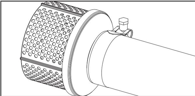
8. Apriete la abrazadera a  $7.4 \pm 1.5$  lbf-ft ( $10 \pm 2$  Nm) con una llave de 13 mm. Si no tiene una llave de torsión, apriete con la mano hasta que la abrazadera esté completamente apretada y, posteriormente, apriete  $\frac{1}{4}$  de vuelta más.
