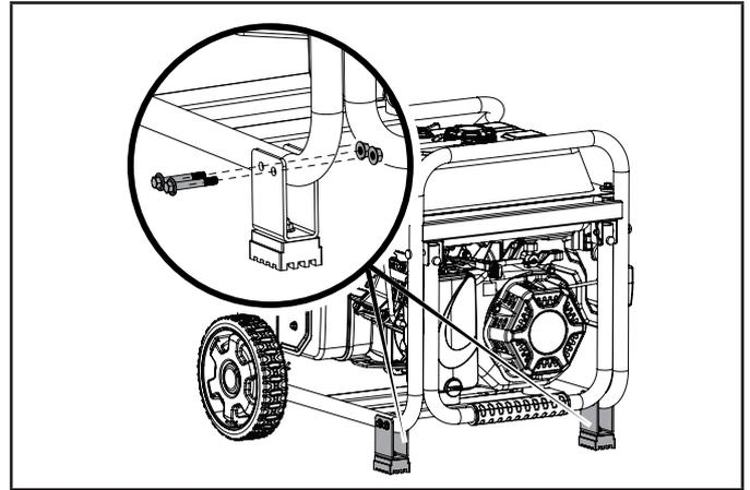
3. Incline lentamente la bomba de agua nuevamente hacia abajo para que descance sobre las patas de apoyo.
