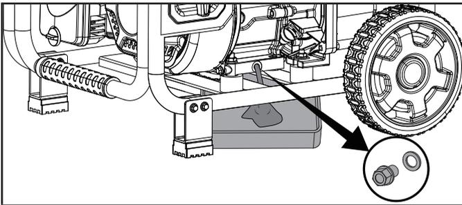
3. Vuelva a colocar el perno de drenaje de aceite. Apriete a 14.7 lbf-ft – 17.6 lbf-ft (20-24 Nm).
