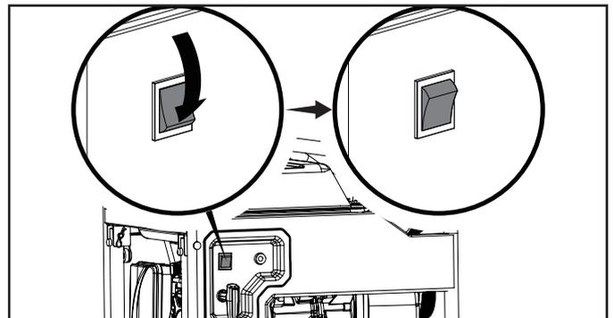
**Importante:** Siempre asegúrese de que la válvula de combustible y el interruptor del motor estén siempre en posición "APAGADO" cuando el generador no esté en funcionamiento.
