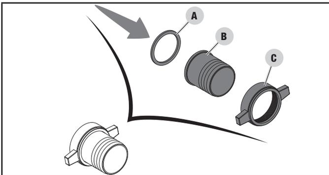
2. Enrosque el conector ya montado al accesorio de conexión de salida (parte superior de la bomba). Localice la etiqueta azul de "salida" en la bomba.
