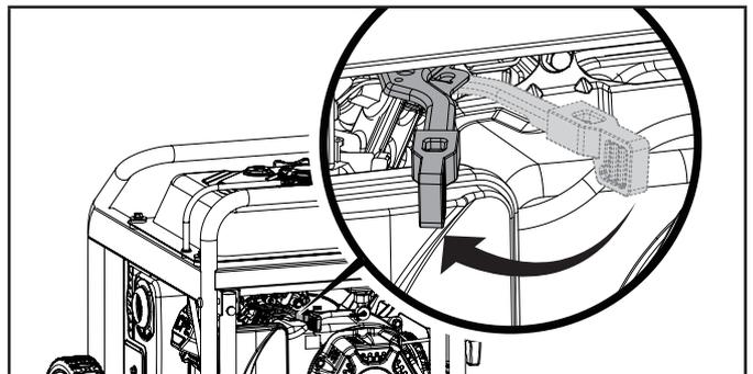
5. Presione el interruptor del motor en la posición "ENCENDIDO".
