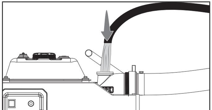
2. A medida que el motor arranca, esto iniciará la extracción de líquido hacia la bomba. La válvula antirretorno está ubicada dentro del conjunto de la bomba. A medida que ceba la caja de la bomba esta válvula de una vía apaga la entrada a la manguera de succión. El proceso de cebado solo es necesario cuando la carcasa de la bomba no está llena de agua.
