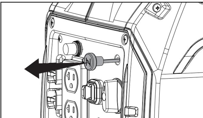
6. Jale la cuerda de arranque lentamente hasta sentir resistencia, luego jale rápidamente.
