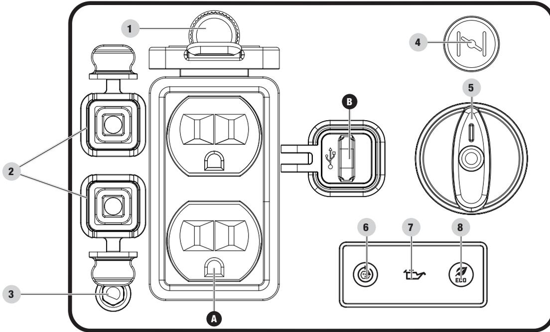
1. **Disyuntores (reinicio a presión)** – Protege el generador contra sobrecargas eléctricas. Presione para reiniciar el disyuntor.
