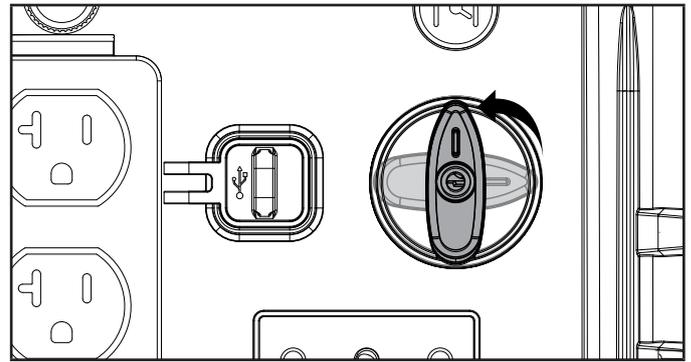
**Importante:** Siempre asegúrese de que el dial de combustible y la palanca de ventilación de combustible estén en posición "APAGADO" cuando el generador no esté en funcionamiento.
