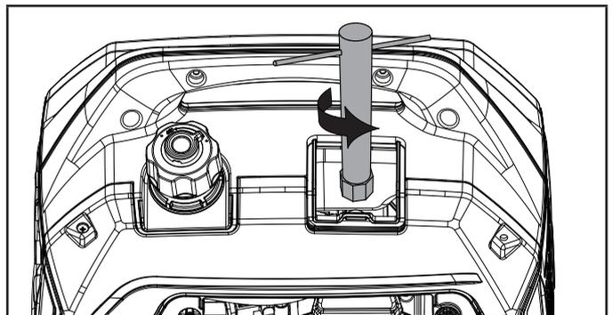
5. Revise el electrodo en la bujía. Debe estar limpio y no desgastado para producir la chispa de encendido.
