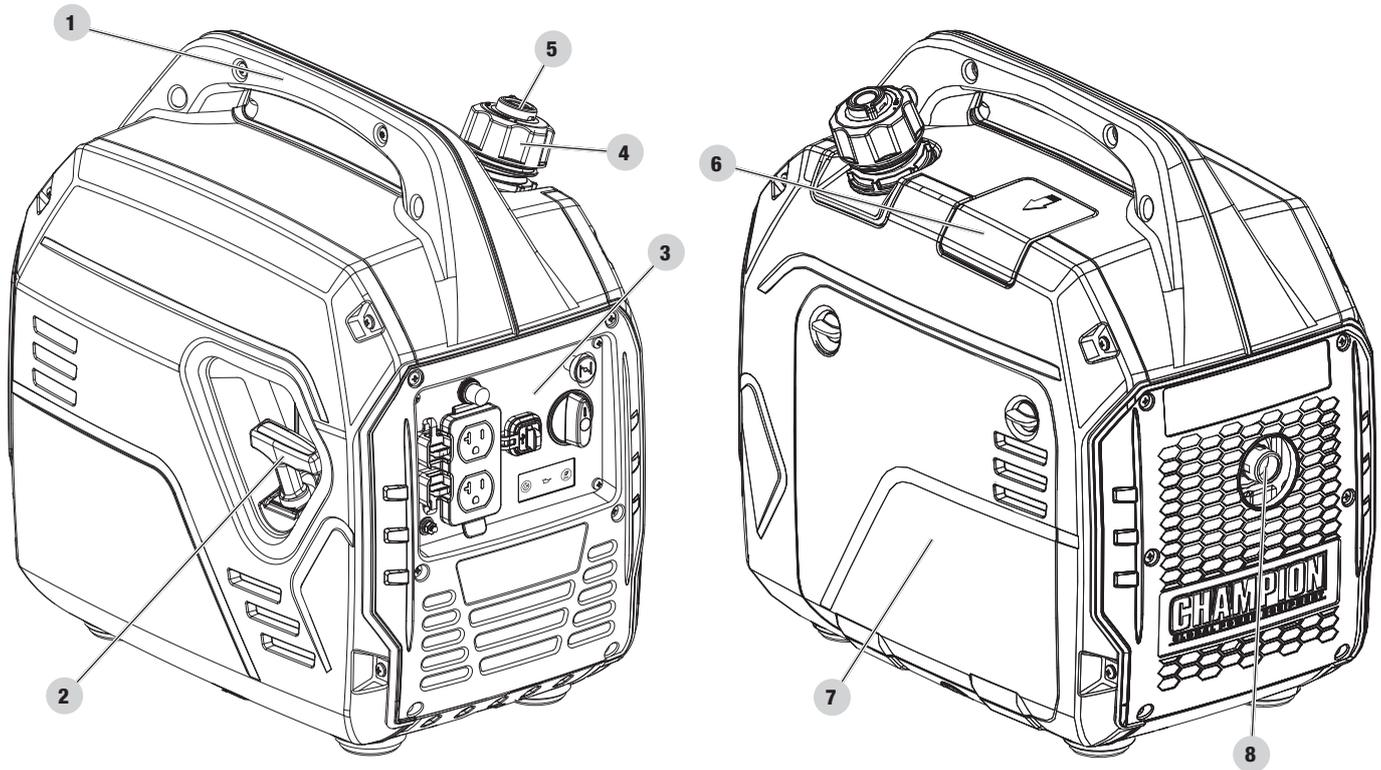
1. **Mango de transporte** – Utilizado para levantar o transportar el generador.
