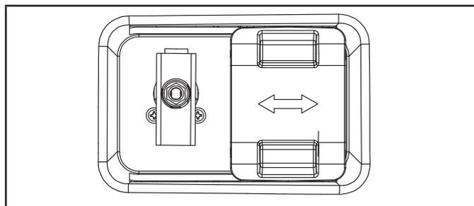
Pour sélectionner l'essence, faites glisser le sélecteur vers la gauche. Tourner le robinet d'essence de 90 ° dans le sens des aiguilles d'une montre.
