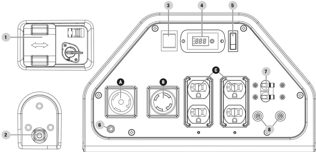
1. **Sélecteur de carburant** – Utilisé pour sélectionner la source d'alimentation d'essence ou de propane (GPL).
