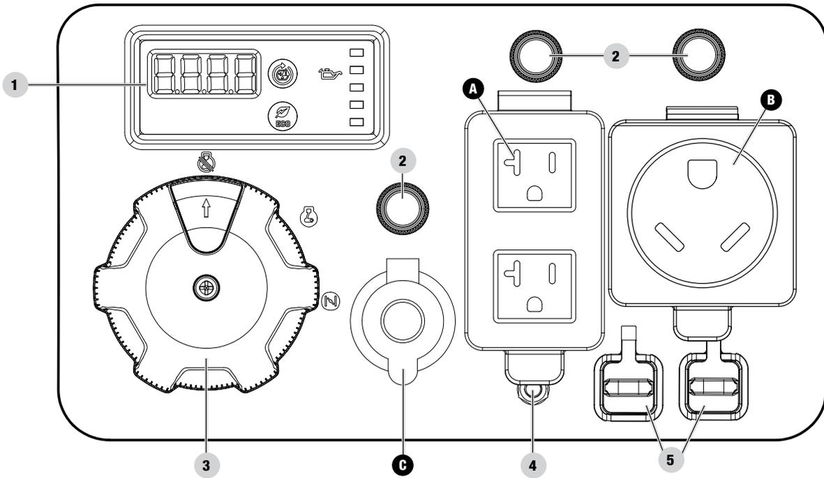
1. **Intelligauge con medidor de potencia**– Consulte la sección *Intelligauge con medidor de potencia*.
