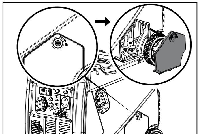
3. Retire la tapa de llenado/varilla de medición de aceite para agregar el aceite.
