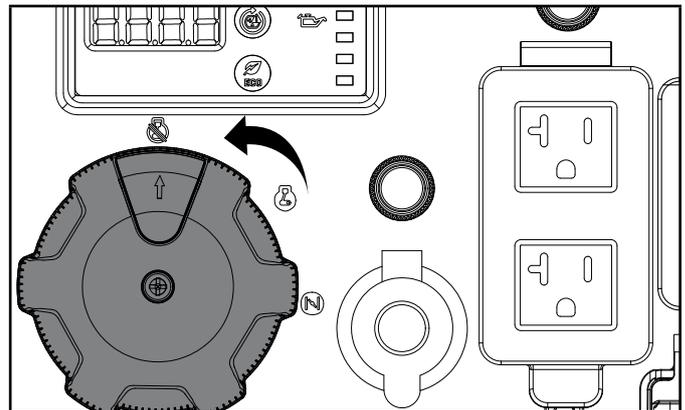
**Importante:** Siempre asegúrese de que el dial EZ Start esta en posición "APAGADO" cuando el generador no esté en funcionamiento.
