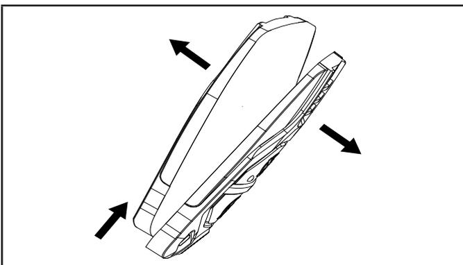
5. Retire con cuidado la placa de circuito para localizar y reemplazar la batería CR2016.
