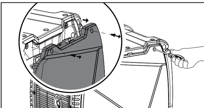
2. Localice la tapa de plástico del filtro de aire y retírela pellizcando los clips y tirando de la tapa.
