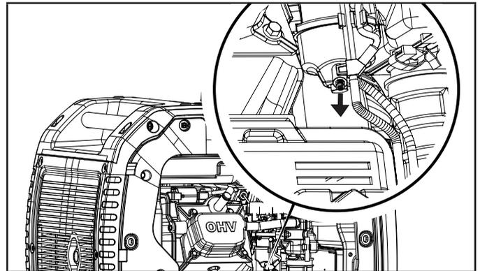
7. Cuando la gasolina pare de fluir del tubo transparente, gire el tornillo de drenaje a reloj (derecha) hasta que se apriete. Deshágase de la gasolina drenada en acuerdo con las regulaciones y normas locales.
