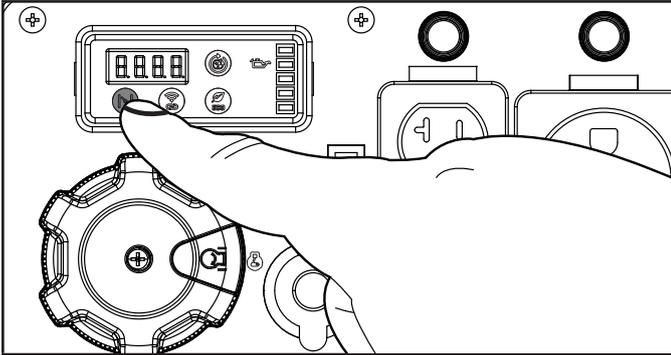
5. Pulse y mantenga pulsado el interruptor de arranque amarillo del dial EZ Start hacia el centro del dial. Suelte cuando el motor comience a arrancar. Si el motor no arranca dentro de cinco segundos, suelte el interruptor y espere al menos diez segundos antes de intentar arrancar el motor de nuevo.
