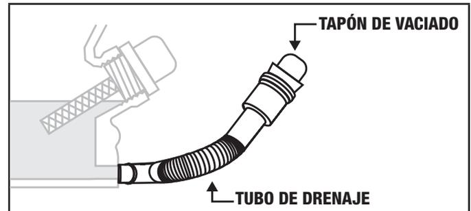
4. Asegúrese de que la manguera de drenaje de aceite esté más bajo que el motor inferior al motor y permita que el aceite drene completamente en un recipiente adecuado.
