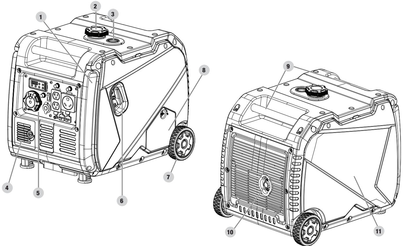
1. **Mango abatible** – Utilizado para mover la unidad al levantar y andar en las ruedas. No lo utilice para levantar o cargar la unidad.
