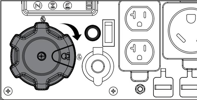
2. Oprima el interruptor de la batería a la posición "ENCENDIDO".
