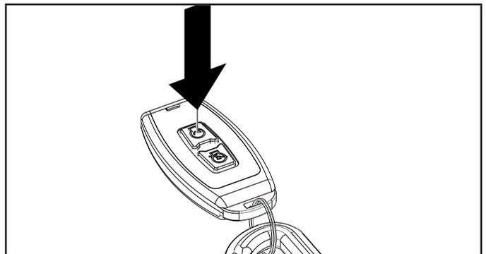
5. Mantenga oprimido el botón establecimiento inalámbrico durante aproximadamente tres (3) segundos hasta que se apague la luz azul del botón de ajuste inalámbrico y la luz verde del botón ENCENDER/APAGAR destelle una vez por segundo indicando que está en modo de "espera".
