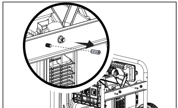
2. Fije la pata de apoyo (E) en el armazón del generador con las tuercas de brida de seguridad (F).
