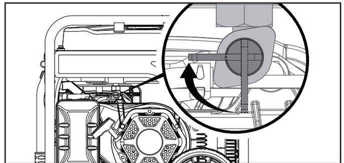
**Importante:** Asegúrese siempre de que el botón ENCENDER/APAGAR esté “APAGADO” y no iluminado y que la válvula de combustible esté en la posición “APAGADO” cuando el generador no se utilice durante un período de tiempo prolongado.
