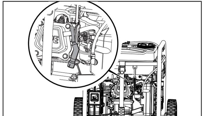
3. Revise el electrodo en la bujía. Debe estar limpio y no desgastado para producir la chispa de encendido.
