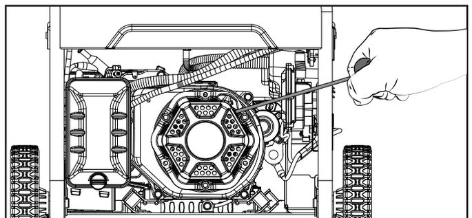
6. Tan pronto como arranque el motor, mueva lentamente el ahogador a la posición "CORRER" por una duración de 2-5 segundos.
