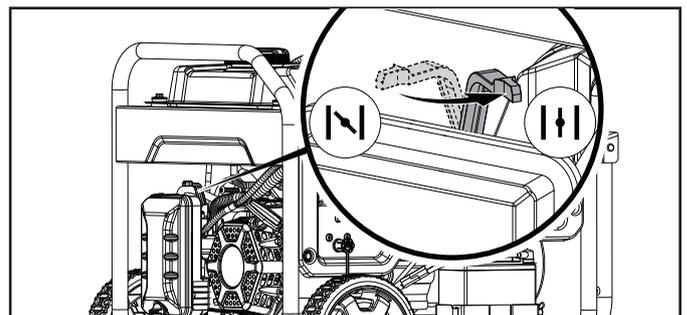
9. Jale la cuerda de arranque lentamente hasta sentir resistencia, luego jale rápidamente.
