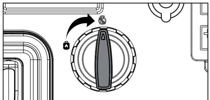
**Importante:** Siempre asegúrese de que la válvula de combustible, el interruptor del motor, y el interruptor de la batería estén siempre en posición "APAGADO" cuando el generador no esté en funcionamiento.
