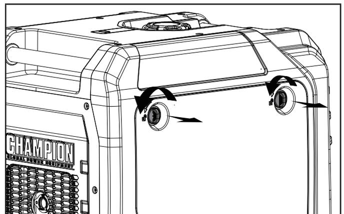
3. Retire la tapa de llenado/varilla de medición de aceite para agregar el aceite.
