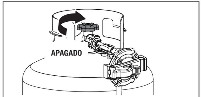
4b. Gire el interruptor de arranque a la posición "APAGADO".
