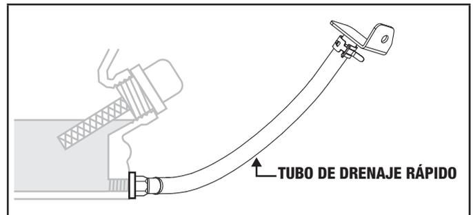
5. Apunte la manguera a una bandeja de drenaje y deje que el aceite drene por completo. NOTA: El extremo de la manguera debe ser inferior a la base del motor para permitir que el aceite drene.
