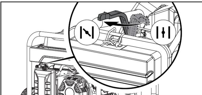
2. Appuyez et maintenez le commutateur d'allumage à la position « START » (démarrage). Relâchez-le dès que le moteur commence à tourner. Si le moteur ne démarre pas dans les cinq secondes, relâchez le commutateur et attendez au moins dix secondes avant de tenter un nouveau démarrage du moteur.
