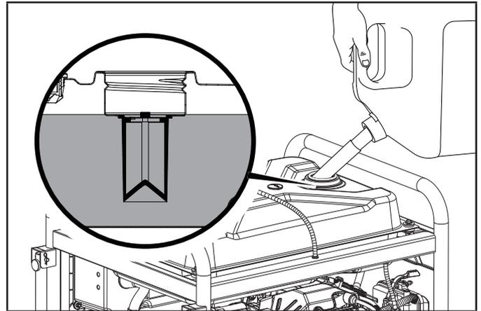
3. Le niveau de carburant approximatif est indiqué sur la jauge à carburant située en haut du réservoir.
