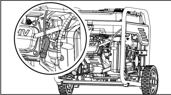
3. Revise el electrodo en la bujía. Debe estar limpio y no desgastado para producir la chispa de encendido.
