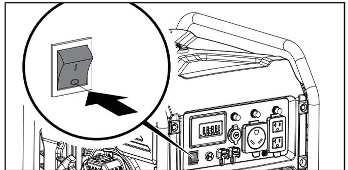
**Importante:** Siempre asegúrese de que la válvula de combustible y el interruptor del motor estén siempre en posición “APAGADO” cuando el generador no esté en funcionamiento.
