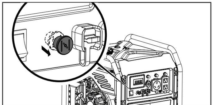
6. Jale la cuerda de arranque lentamente hasta sentir resistencia, luego jale rápidamente.
