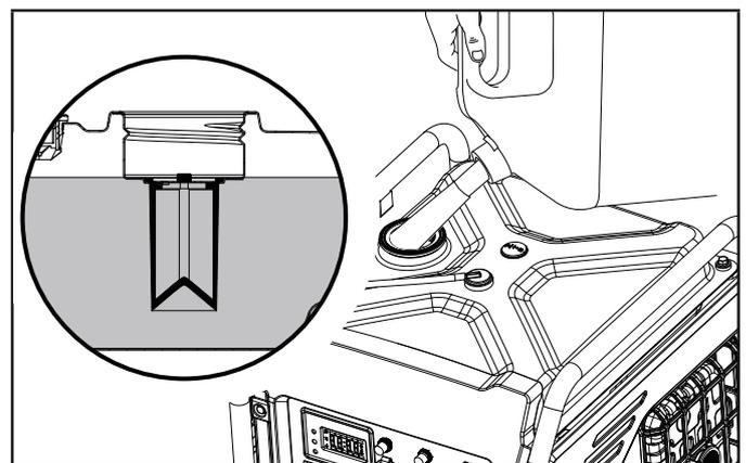
2. El nivel de combustible aproximado se muestra en el medidor de combustible en la parte superior del tanque de combustible.
