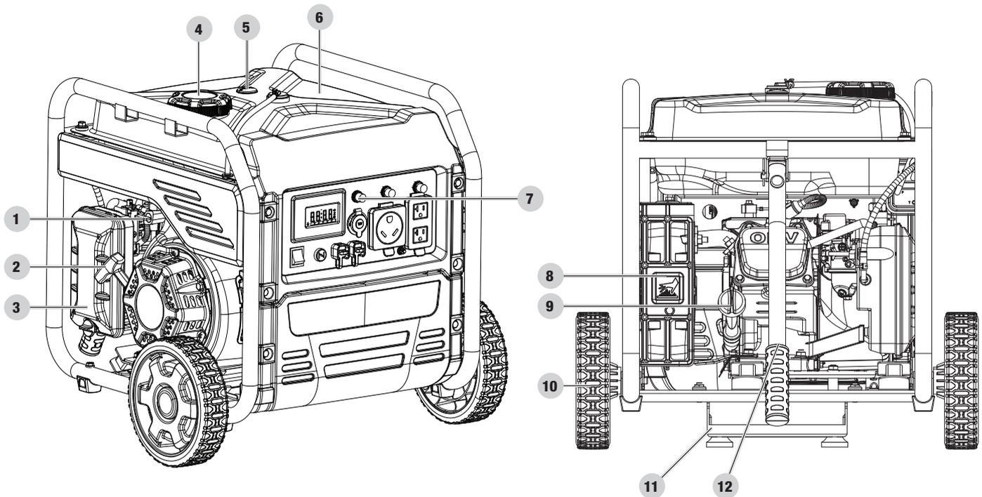
1. **Válvula de combustible** – Utilizado para apagar o encender el suministro de combustible.
