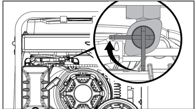
4. Si el generador no se utiliza durante 2 semanas o más, deje que el motor funcione hasta que el generador se detenga por falta de combustible. Esto evita la posible adherencia al sistema de combustible, que normalmente toma unos minutos. Si planea usar el generador en las próximas dos semanas, vaya al paso 5.
