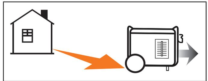
Si elle est mal utilisée et fonctionne dans un endroit où peut s'accumuler du CO à l'intérieur d'un espace fermé ou partiellement fermé, par exemple une maison, un garage ou un garage dont la porte est partiellement ouverte, le dispositif CO Shield® éteindra automatiquement la génératrice et un témoin DEL rouge s'allumera. Lisez l'étiquette d'intervention pour connaître les étapes à suivre. **Le dispositif CO Shield® ne remplace pas un détecteur de monoxyde de carbone d'intérieur.**
