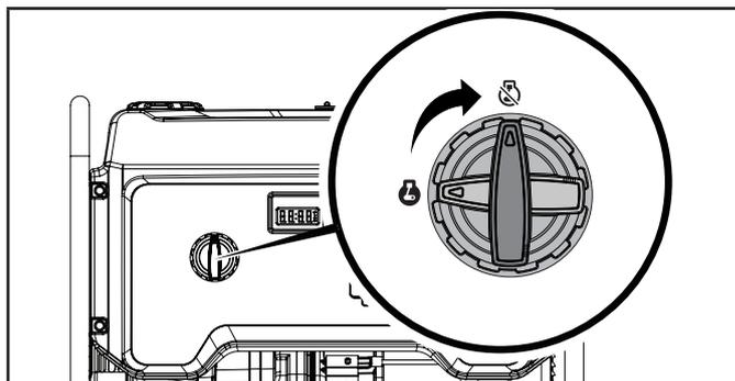
**Important :** Assurez-vous toujours que le cadran de carburant est en position « ARRÊT » lorsque la génératrice n'est pas utilisée.
