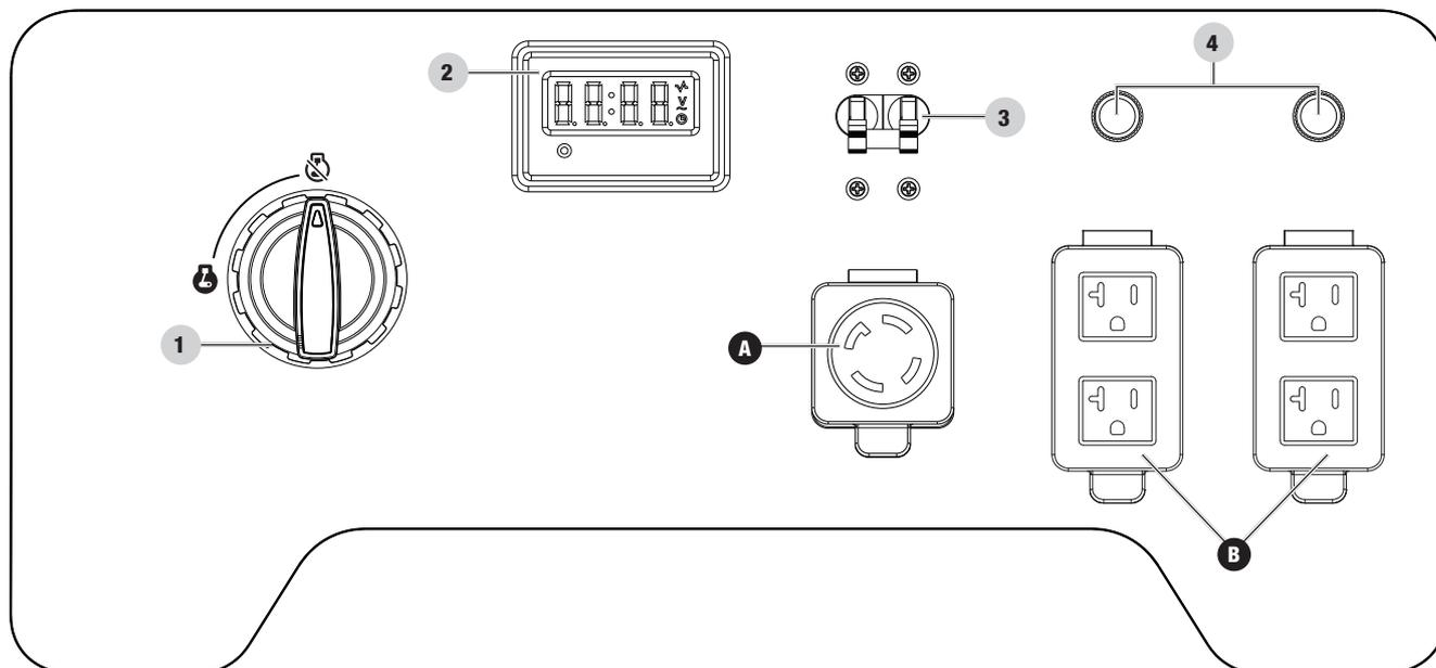
1. **Cadran de carburant** – Utilisé pour démarrer, arrêter.
