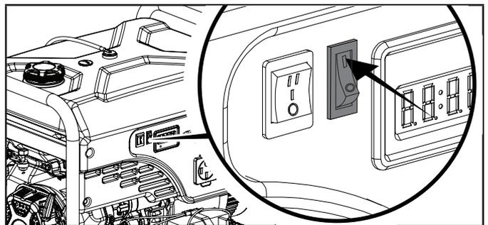
2. Pulse y mantenga pulsado el interruptor de arranque a la posición "ARRANCAR." Suelte cuando el motor comience a arrancar. Si el motor no arranca dentro de cinco segundos, suelte el interruptor y espere al menos diez segundos antes de intentar arrancar el motor de nuevo.
