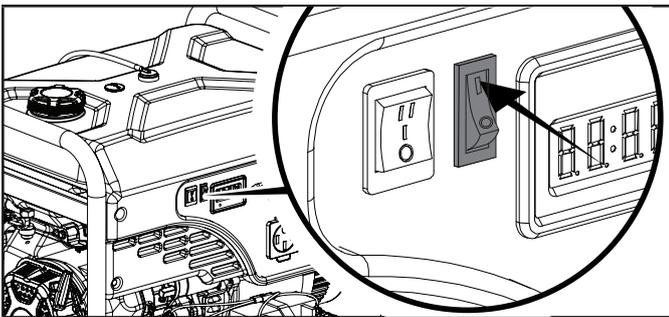
2. Oprima el interruptor de arranque a la posición "ENCENDIDO."
