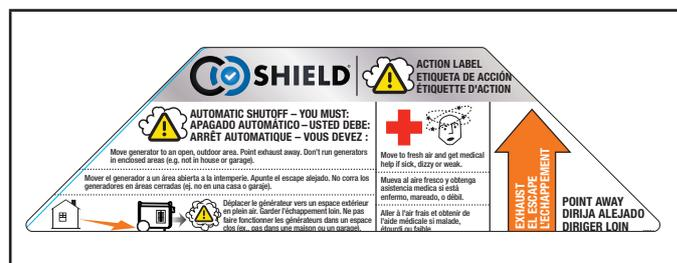
Cuando se acerque al generador para investigar un apagado, una luz LED **roja** destallando en el área del CO Shield® provee la notificación que el generador se apago debido a una acumulación peligrosa de CO. La luz roja LED destallará por lo menos cinco (5) minutos después de un evento de apagado.
