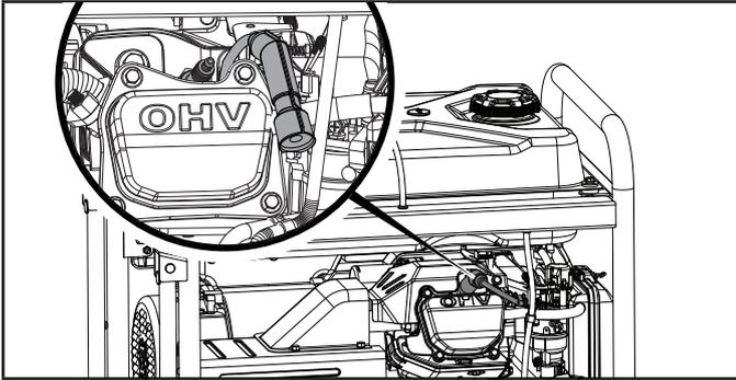
3. Revise el electrodo en la bujía. Debe estar limpio y no desgastado para producir la chispa de encendido.
