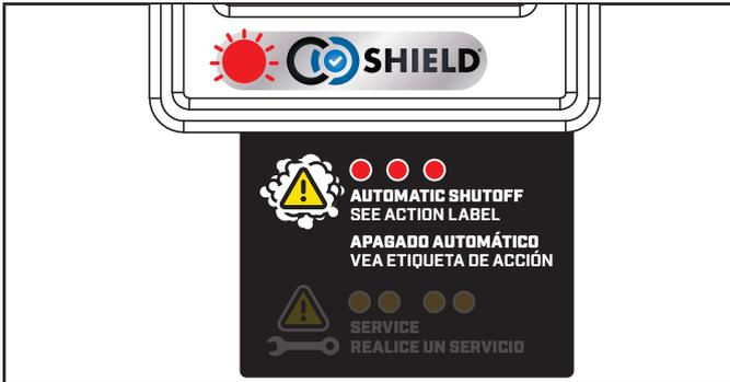
Mueva el generador a un área abierta al intemperie, y dirija el escape afuera de personas e inmuebles. Una vez que se haya re-ubicado a un área segura, el generador puede reiniciarse, y las conexiones apropiadas se pueden hacer. Introduzca aire fresco y ventile la locación en donde el generador se apago.
