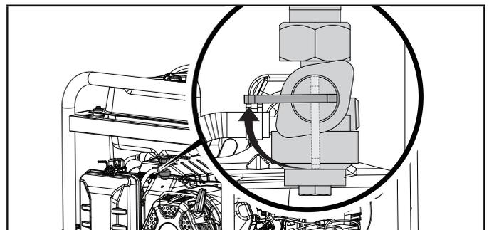
**Importante:** Siempre asegúrese de que la válvula de combustible, interruptor de arranque, y el interruptor de la batería estén siempre en posición “APAGADO” cuando el generador no será utilizado por un periodo extendido.
