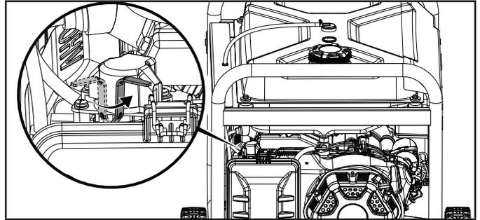
4. Jale la cuerda de arranque lentamente hasta sentir resistencia, luego jale rápidamente.
