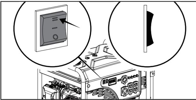
2. Oprima el interruptor de la batería a la posición "ENCENDIDO".
