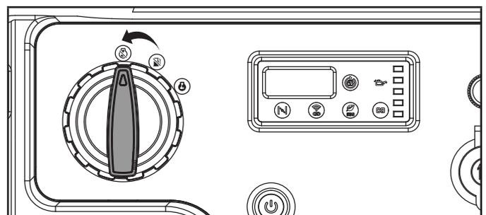
**Importante:** Siempre asegúrese de que el botón Encender/Apagar esté “APAGADO” y no iluminado y que el dial de combustible esté en la posición “APAGADO” cuando el generador no será utilizado por un periodo extendido.
