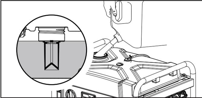
3. El nivel de combustible aproximado se muestra en el medidor de combustible en la parte superior del tanque de combustible.
