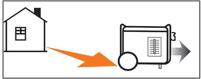
Si es mal usado y operado en una locación que resulta en la acumulación de CO adentro de un espacio cerrado o parcialmente cerrado, por ejemplo una casa, garaje o garaje con la puerta parcialmente abierta, el CO Shield automáticamente apagará el motor y después iluminará una luz LED roja. Lea la etiqueta de acción para los pasos que debe tomar. **El CO Shield no es un sustituto para una alarma de detección de monóxido de carbono para el interior.**
