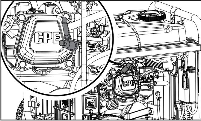
3. Revise el electrodo en la bujía. Debe estar limpio y no desgastado para producir la chispa de encendido.
