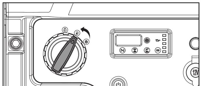
6. Permita que el generador corra hasta que el motor se detenga completamente de la falta de combustible.
