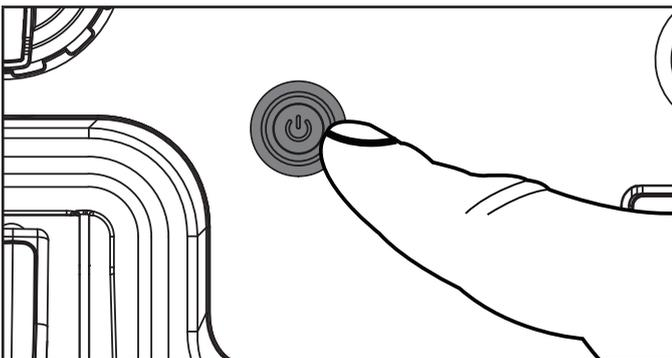
4. Oprima el botón Encender/Apagar para arrancar el motor. Si el motor no arranca, espere al menos diez segundos antes de intentar arrancar el motor de nuevo.
