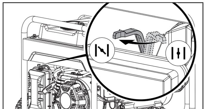
7. AMORÇAGE PAR TRACTION : Tirez lentement la corde du démarreur jusqu'à ce que vous ressentiez une résistance puis tirez rapidement. Tirez 2 à 3 fois pendant que l'étrangleur est à 100 % jusqu'à ce que quelques réactions de combustion se produisent indiquant ainsi que le moteur a amorcé le démarrage.
