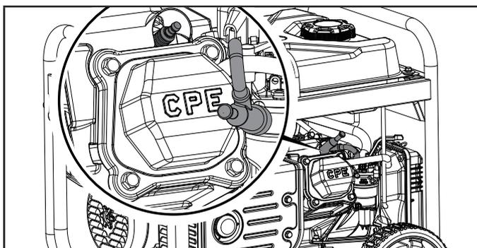
3. Inspectez l'électrode de la bougie. Elle doit être propre et sans usure afin de produire l'étincelle requise au démarrage.
