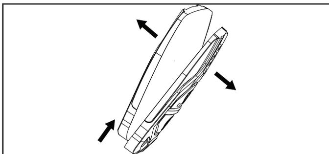
5. Retirez délicatement le circuit imprimé pour localiser et remplacer la pile CR2016.
