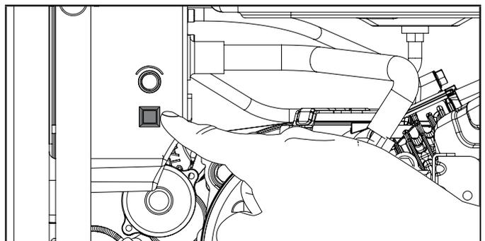
7. Suivez les instructions de démarrage et d'arrêt à distance pour vérifier que la ou les télécommandes fonctionnent correctement.
