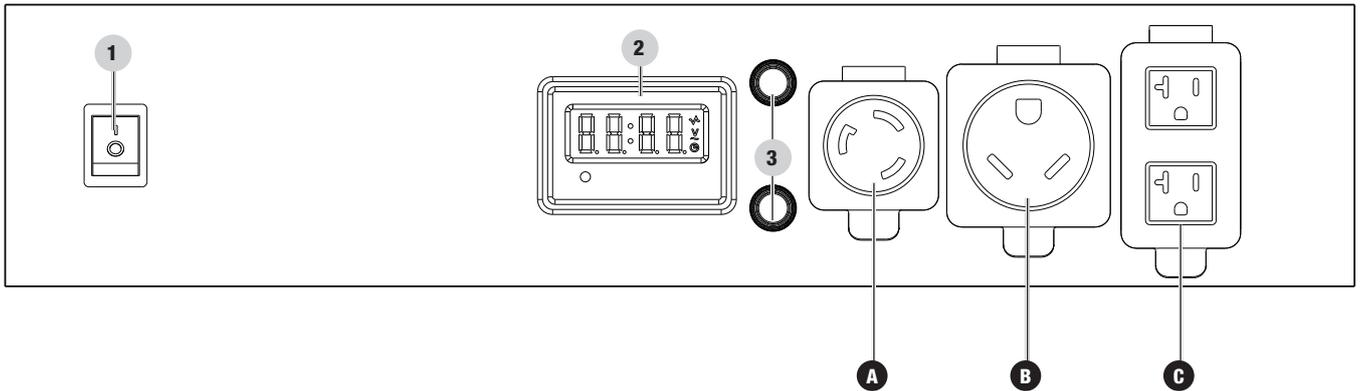
1. **Interruptor del motor** – Se utiliza para poner en modo ENCENDER o para APAGAR el generador.
