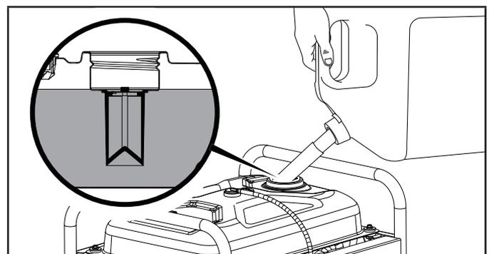
3. El nivel de combustible aproximado se muestra en el medidor de combustible en la parte superior del tanque de combustible.
