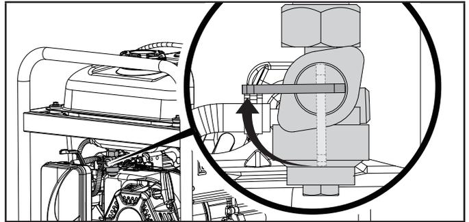
**Importante:** Siempre asegúrese de que la válvula de combustible y el interruptor del motor estén siempre en posición "APAGADO" cuando el generador no esté en funcionamiento.
