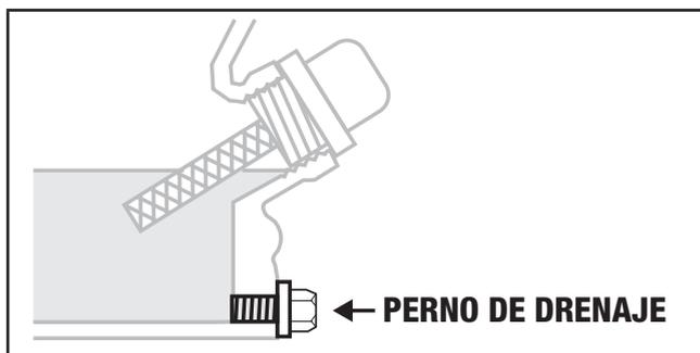
5. Agregue 0.6 qt. (0.6 L) de aceite y vuelva a colocar la tapa de llenado/varilla indicadora de aceite.
