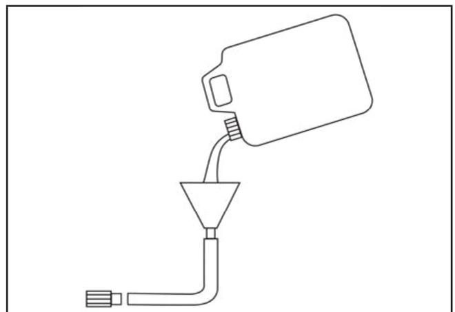
5. Vierta el anticongelante por el embudo, luego pulse el arrancador retráctil del motor para crear aspiración en la caja de la bomba. Jale el arrancador varias veces hasta que el anticongelante salga por la salida de la bomba.
