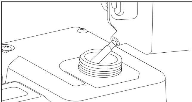
6. Atornille la tapa del tanque y limpie con un paño todo el combustible derramado.
