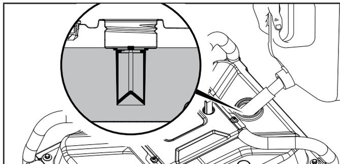
3. Le niveau de carburant approximatif est indiqué sur la jauge à carburant située en haut du réservoir.
