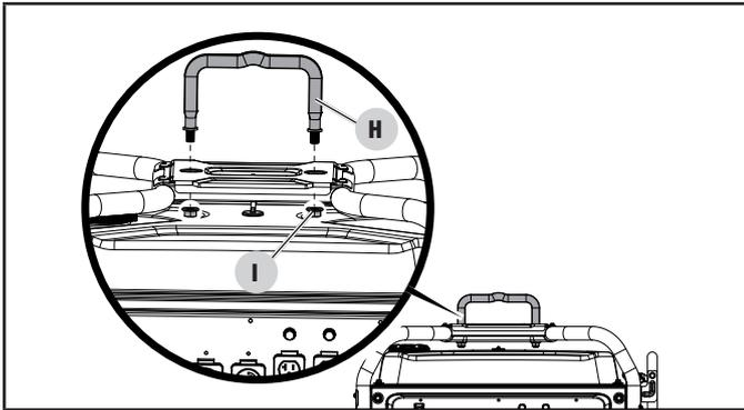
2. Serrez solidement les boulons à un couple de 17 à 22 pi-lb.
