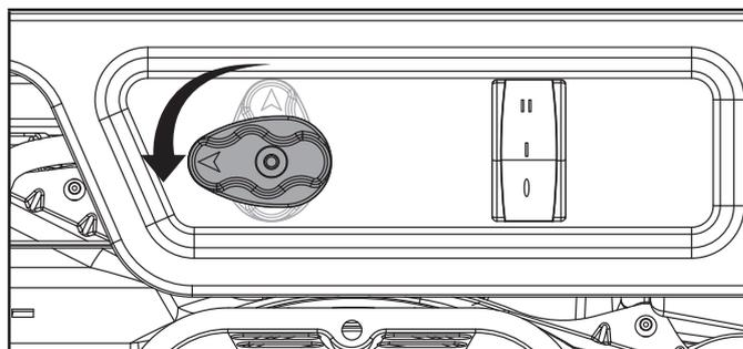
**Important :** Assurez-vous toujours que le robinet d'alimentation en combustible et l'interrupteur de moteur sont en position « ARRÊT » lorsque la génératrice n'est pas utilisée.
