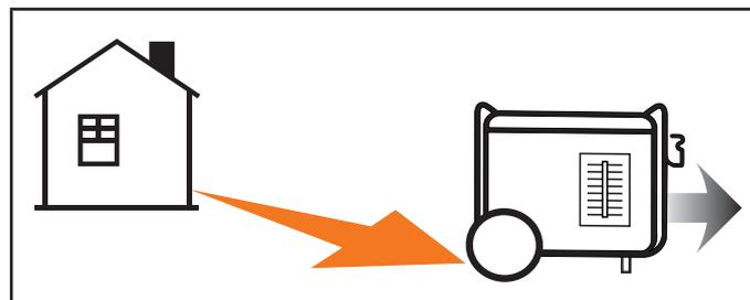
Si elle est mal utilisée et fonctionne dans un endroit où peut s'accumuler du CO à l'intérieur d'un espace fermé ou partiellement fermé, par exemple une maison, un garage ou un garage dont la porte est partiellement ouverte, le dispositif CO Shield® éteindra automatiquement la génératrice et un témoin DEL rouge s'allumera. **Lisez l'étiquette d'intervention pour connaître les étapes à suivre.**
