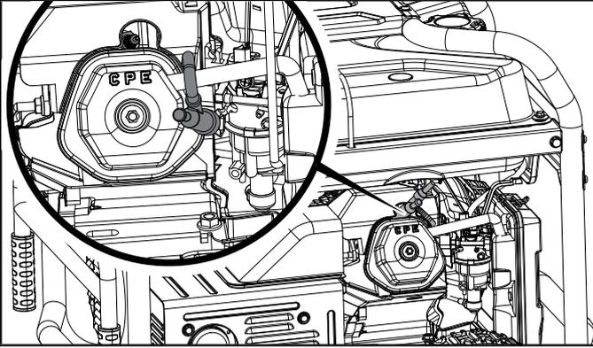
3. Inspectez l'électrode de la bougie. Elle doit être propre et sans usure afin de produire l'étincelle requise au démarrage.
