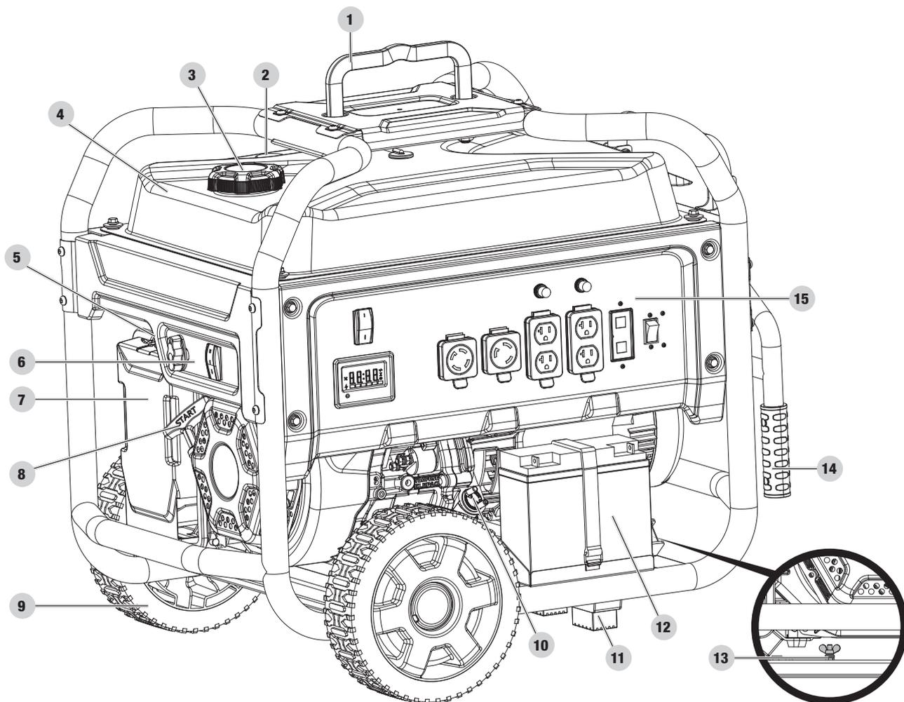
1. **Crochet de levage** – Utilisé pour soulever le générateur.
